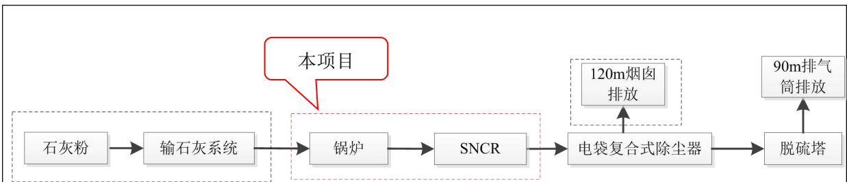
图2-2 热电站煤锅炉烟气治理工艺流程图
